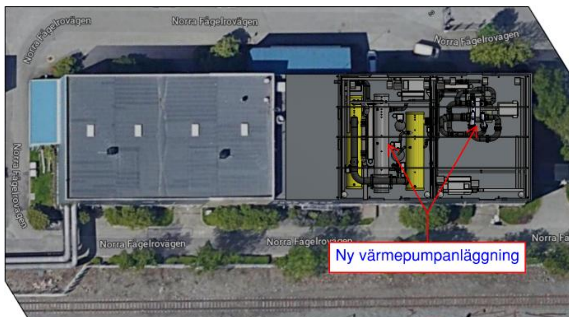
Figur 10. Översikt placering av värmepumpanläggning.
